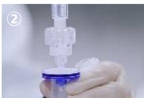
再構成した酵素溶液がチューブに5ml採取できるまで、シリンジ内の水をTDzyme®カートリッジにゆっくりと注入します。
