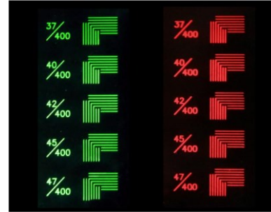
Cdベース量子ドットカラーフィルターの光学安定性試験データ（左）、現像精度（右）
